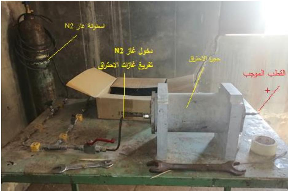
الشكل (8) جهاز قياس معدل الاحتراق
