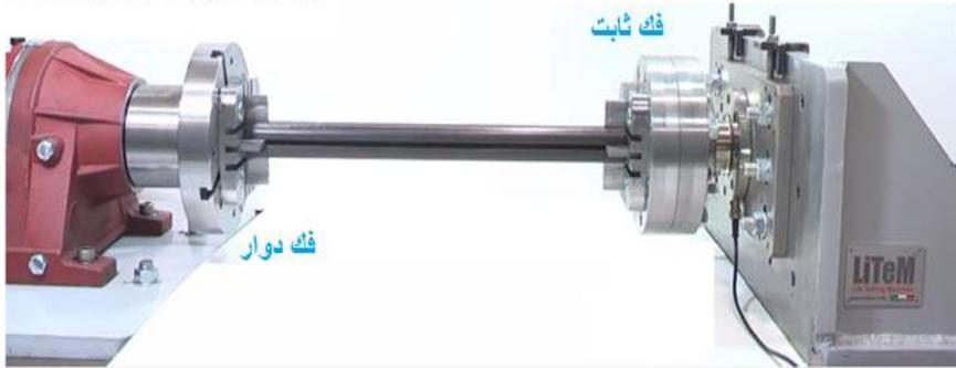
الشكل (5) صورة لآلة اختبار على التعب بفعل الفتل [6]
