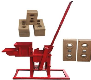
الشكل 14 يبين مكبس يدوي المستخدم لتصنيع الطوب.
