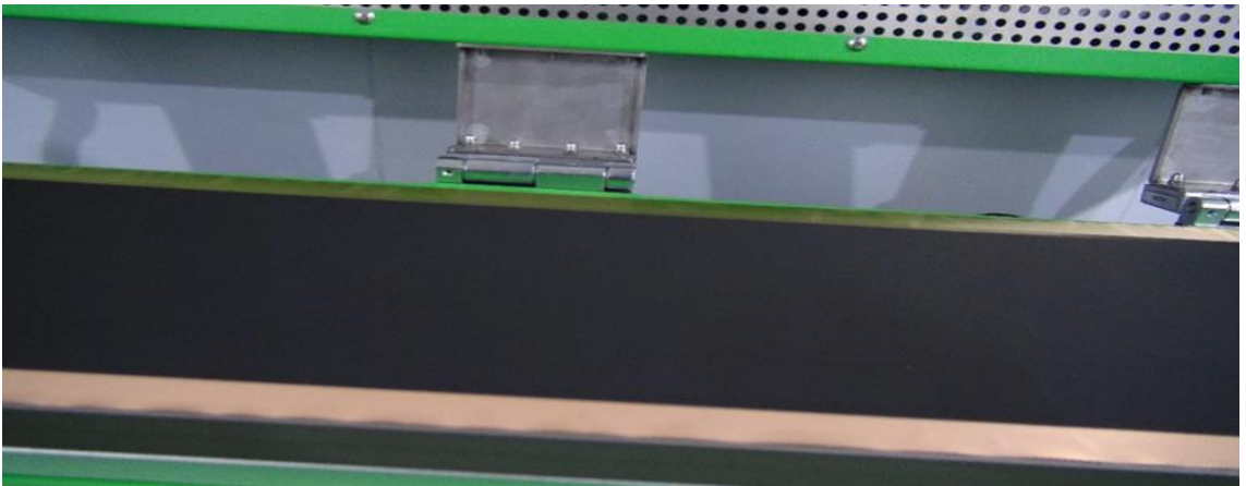
الشكل (10) الأنود باستعمال مادة الـPVDF بعد الجفاف
