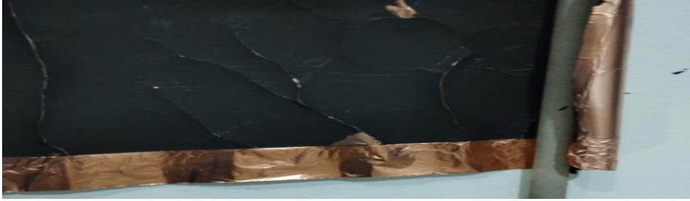
الشكل (13) انهيار طبقة الطلاء عند استعمال نسبة 5% مادة رابطة
